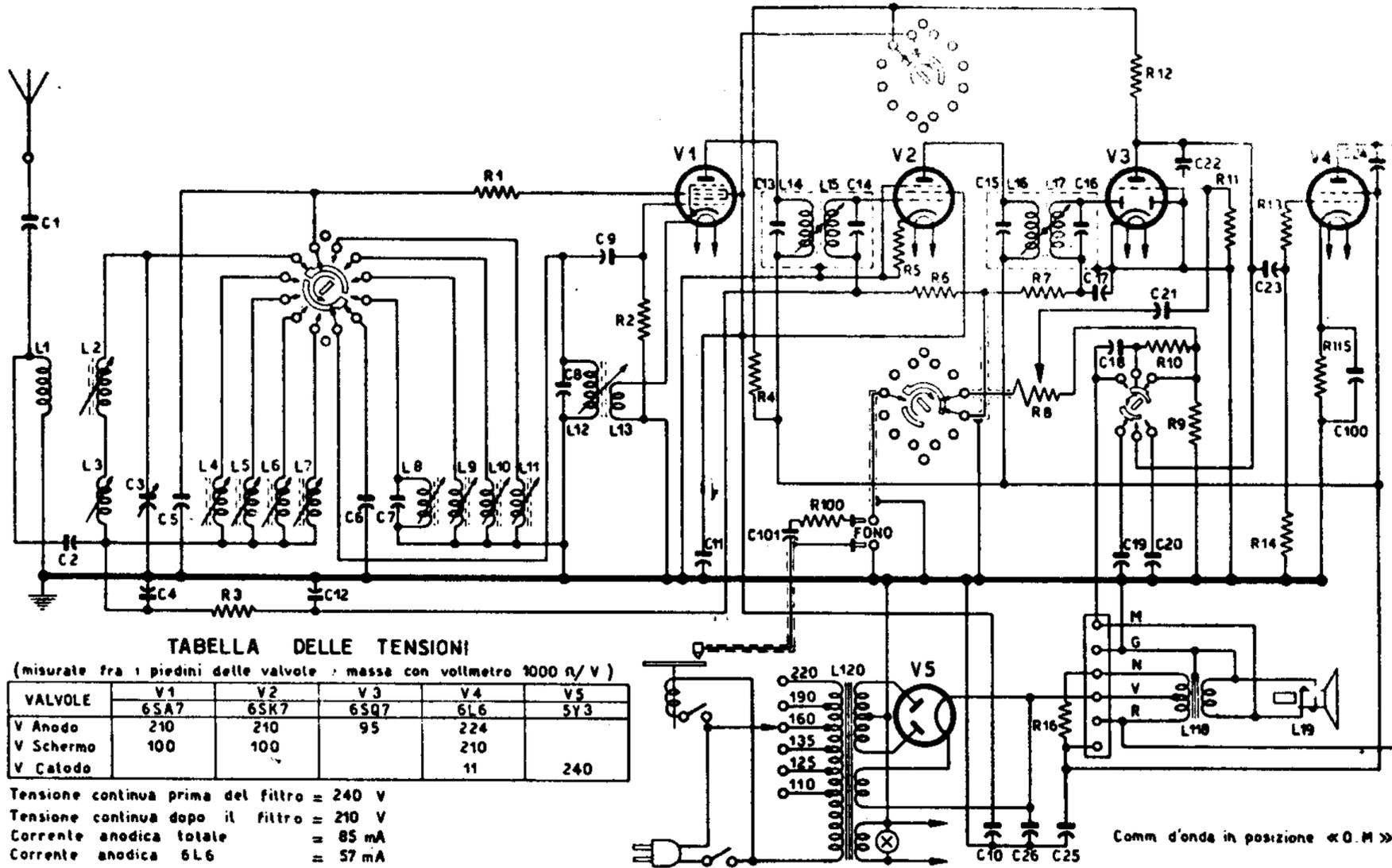
ATTENZIONE - A partire dalla matricola N. 12931 le valvole 6SA7 e 6SK7 vengono sostituite rispettivamente dalle valvole miniatura 6BE6 e 6BA6.
